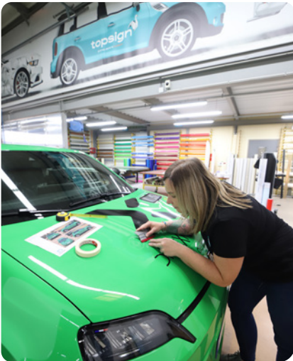
Elodie - en pleine finition de pose vinyle sur un véhicule d'auto-école dans notre atelier dédié.
